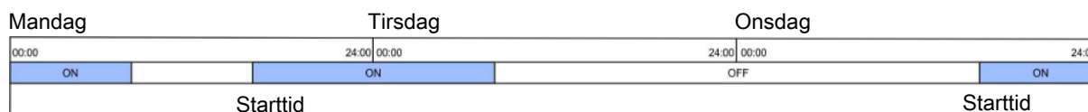
Figur 16: Hvis en ON-tid løber over midnat på et døgn, hvor uret ikke er aktivt, vil funktionen forblive ON, indtil tiden er udløbet.
